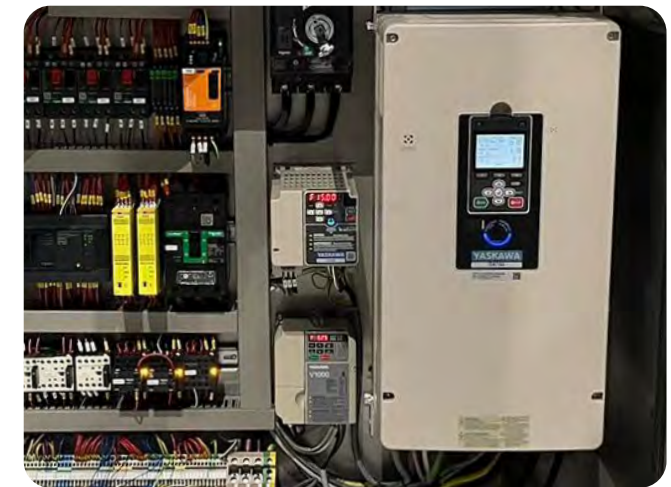
Démarrage et arrêt en douceur des couteaux, de la cuve et disque déchargeur grâce aux variateurs de vitesse.
